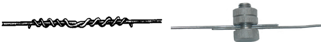
不良连接方式示例 1：绕接
